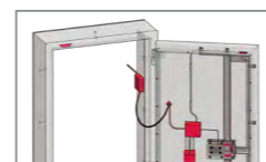
Système d'alarme à raccorder à la centrale
